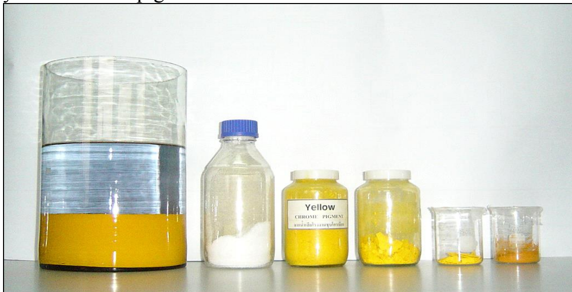
เม็ดสีเหลือง Chrome Pigment ที่ผลิตจากน้ำเสีย โรงงานชุบโครเมียม
